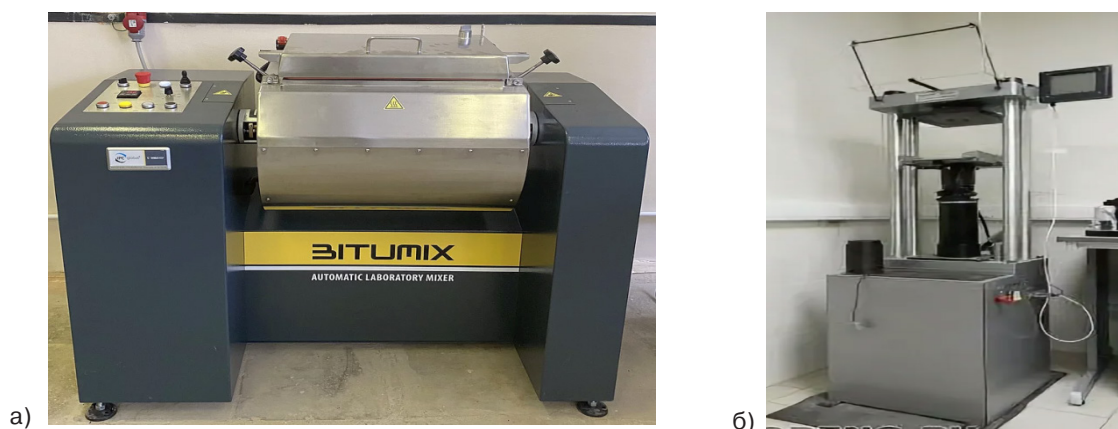
Рис. 1. Оборудование для производства образцов асфальтобетона: а – смеситель BITUMIX; б – гидравлический пресс ИП-1А-500 АБ ПК
