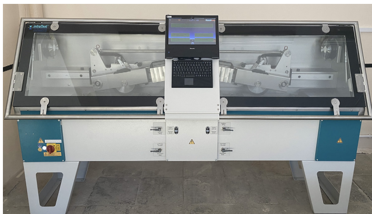
Рис. 3. Установка для проведения испытаний на колееобразование «Infratest»
