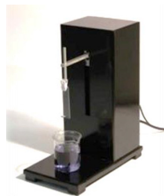
Рис. 5. Фотографическое изображение установки для проведения dip-coating синтеза
