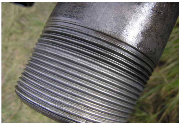
Рис. 3. Резьбовое соединение НКТ после диффузионного оцинкования
